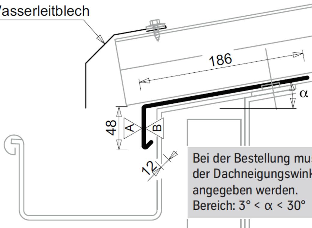
Bei der Bestellung muss der Dachneigungswinkel  $\alpha$  angegeben werden.
